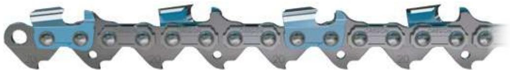
Un opción ideal para usuarios que regularmente utilizan motosierras para el mantenimiento de propiedades y poda de árboles. Dientes de corte Micho Chisel de baja vibración que cuentan con un pequeño radio en las equinas de corte para un desempeño excelente y de fácil mantenimiento. Diseño con bajo nivel de golpe de retroceso.
