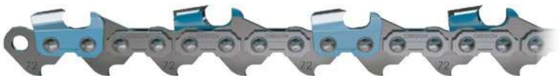
Una cadena ideal para cortadores profesionales que utilizan paso de cadena 3/8". Cadena de baja vibración y dientes de corte Full Chisel que ofrecen el mejor desempeño. La medida del calibrador de profundidad está diseñada para evitar que los dientes de corte se claven en la pared lateral del corte, ofreciendo un corte más suave.
