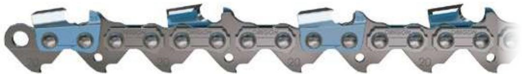
Una cadena ideal para cortadores de madera profesionales que utilizan paso de cadena .325". Cadena de baja vibración y dientes de corte Full Chisel que ofrecen el mejor desempeño. La medida del calibrador de profundidad está diseñada para evitar que los dientes de corte se claven en la pared lateral de la madera, ofreciendo un corte más suave.
